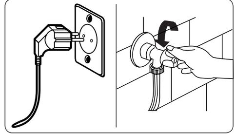
أوقف تشغيل مصدر التيار الكهربائي وانزع القابس من المقبس قبل إجراء صيانة الغسالة وتنظيفها.
