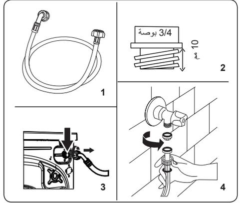
1. قد تكون للغسالة إما وصلة دخول مياه مفردة (للمياه الباردة) أو وصلة مزدوجة لدخول المياه (للمياه الساخنة والباردة) وفقاً لمواصفات الغسالة. يجب ربط الخرطوم ذي الطرف الأبيض بمدخل الماء البارد، وربط الخرطوم ذي الطرف الأحمر بمدخل الماء الساخن (إن وجد).
